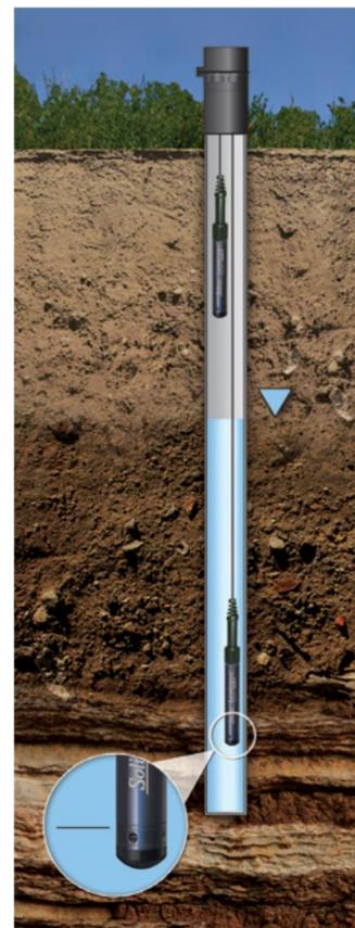
Esquema de instalación de datalogger
