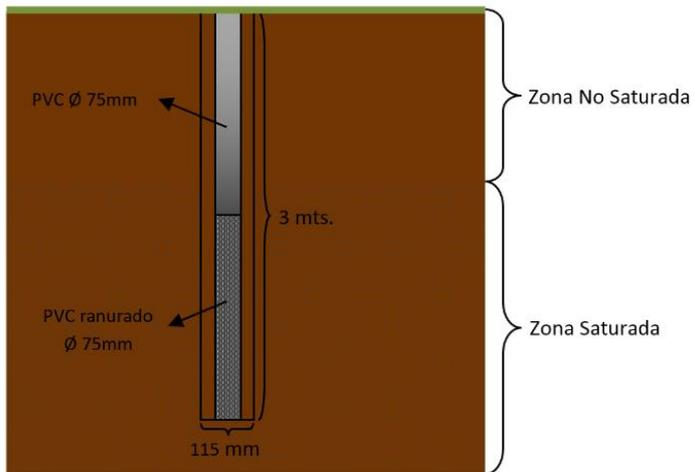
Esquema constructivo de piezómetro
