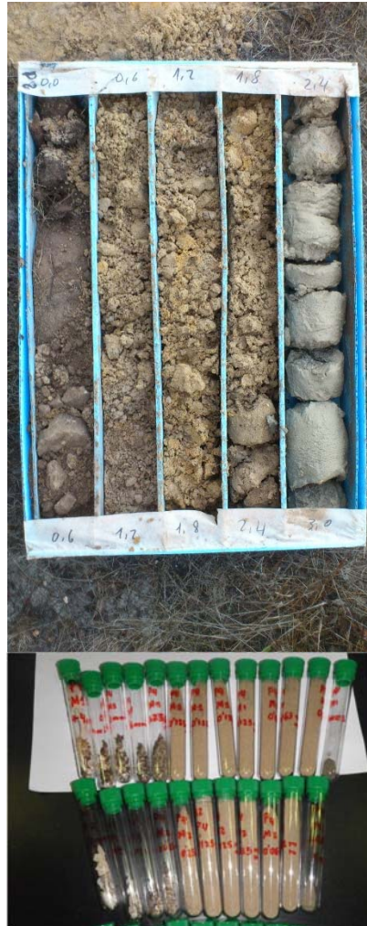
Arriba: Caja de testigos obtenida en una perforación. Abajo: resultado del tamizado
