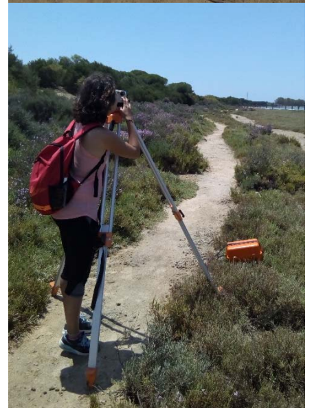
Arriba: material utilizado para la nivelación de precisión. Abajo: alumna realizando medidas de nivelación
