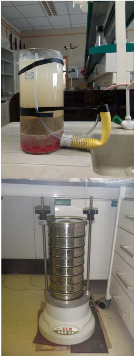
Determinaciones de laboratorio. Arriba: permeámetro de carga variable. Abajo: columna de tamizado para granulometría.
