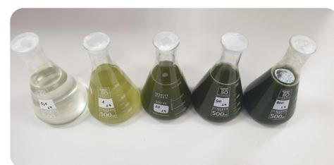
Fig 3. Diluciones de biomasa de microalgas. Conductividad < 700 µS/cm
