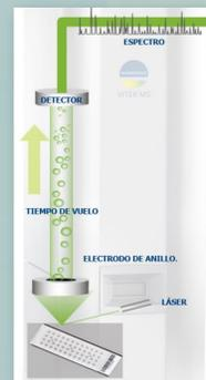
Figura 3: Proceso de análisis de muestras mediante MALDI-TOF MS.
